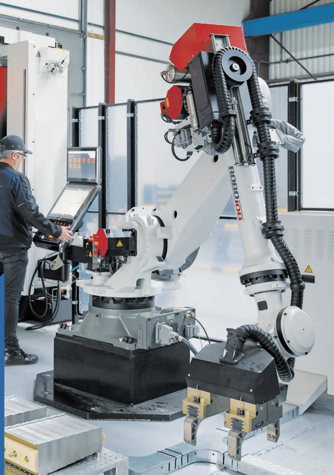
使用VARIAXIS i-800 NEO和工业机器人，以24小时工作体制加工大型零件
