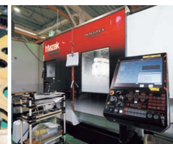
加工形状复杂零件的INTEGREX i-200H S
