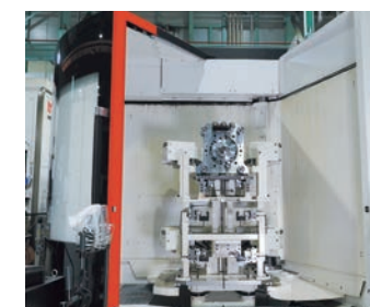
为加工发动机箱而配备了特殊定制规格 夹紧角度头刀架的INTEGREX e-1250V/8
