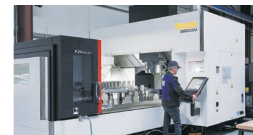
实现高精度加工的高刚性龙门加工中心FJV-60/80
