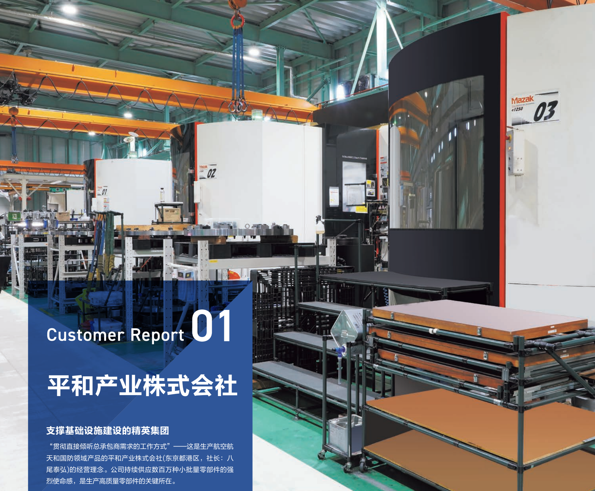
24小时全天候运转的龙门复合加工机 INTEGREX e-1250V/8
